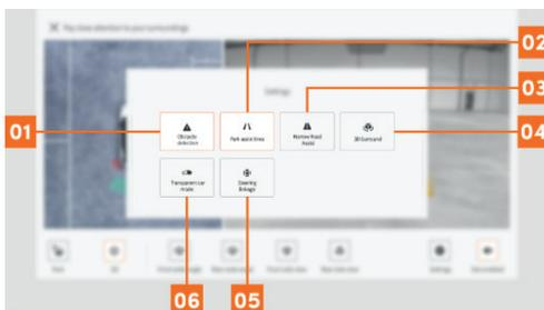
■ Обнаружение препятствий: При активации системы обнаружения препятствий и срабатывании сигнализации парковочного радара в зонах А и В отображаются красные, желтые и зеленые световые волны. Красная световая волна отображается, когда расстояние до препятствия минимально.
