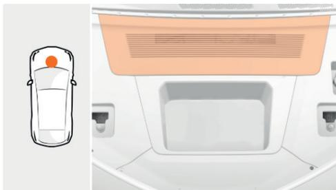
Чтобы поддерживать нужную температуру в силовом агрегате автомобиля, через него проходит охлаждающая жидкость. Необходимо регулярно проверять уровень охлаждающей жидкости и поддерживать его на уровне MIN и MAX отметки.
