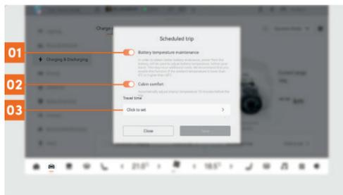
**Поддержание температуры батареи:** Система будет использовать электроэнергию из сети, чтобы отрегулировать температуру батареи до запланированного времени отправления, что увеличит мощность и запас хода автомобиля.
