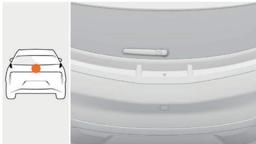
Когда автомобиль заблокирован, поднесите UWB-ключ к двери багажника и нажмите на микропереключатель на двери багажника, чтобы открыть ее автоматически.
